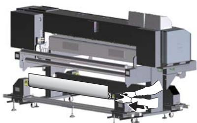
リアロールユニット（反原点側）を動かし、ロールメディアに取り付けます。
