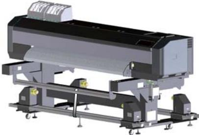
フロントテンションローラーが移動時に動かないように固定します。
