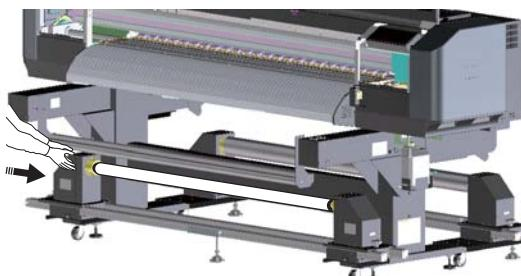
フロントロールユニット（反原点側）を動かし、紙管に取り付けます。
