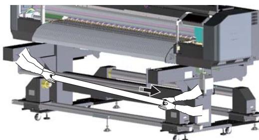
フロントロールユニット（原点側）に、紙管を取り付けます。
